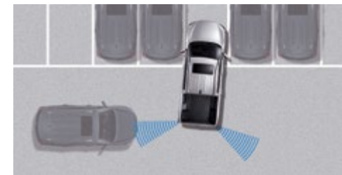
Radar ruchu poprzecznego z tyłu pojazdu (RCTA) Kiedy podczas cofania zostanie wykryte zbliżanie się samochodu z tyłu, po obu stronach pojazdu, RCTA włączy dźwiękowy sygnał alarmowy i uruchomi hamulce, aby zapobiec kolizji.
