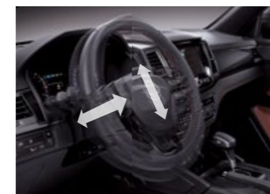
Regulacja pochylenia kolumny kierownicy w obu kierunkach
