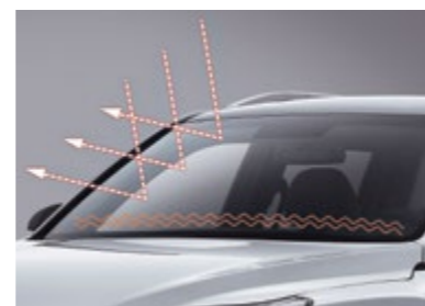
Szyba przednia atermiczna z systemem odmrażania wycieraczek
